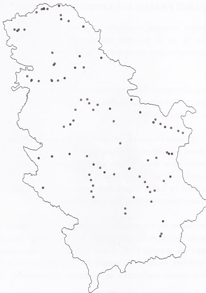
Слика 6.29 Распоред тачака за уклапање (плави симбол) и независну контролу (црвени симбол)
