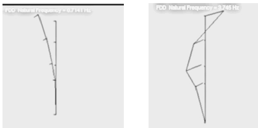
Slika 4 – Sopstveni modovi određeni na osnovu merenja prema DISP-1 ambijentalnih merenja ubrzanja na konstrukciji dimnjaka
