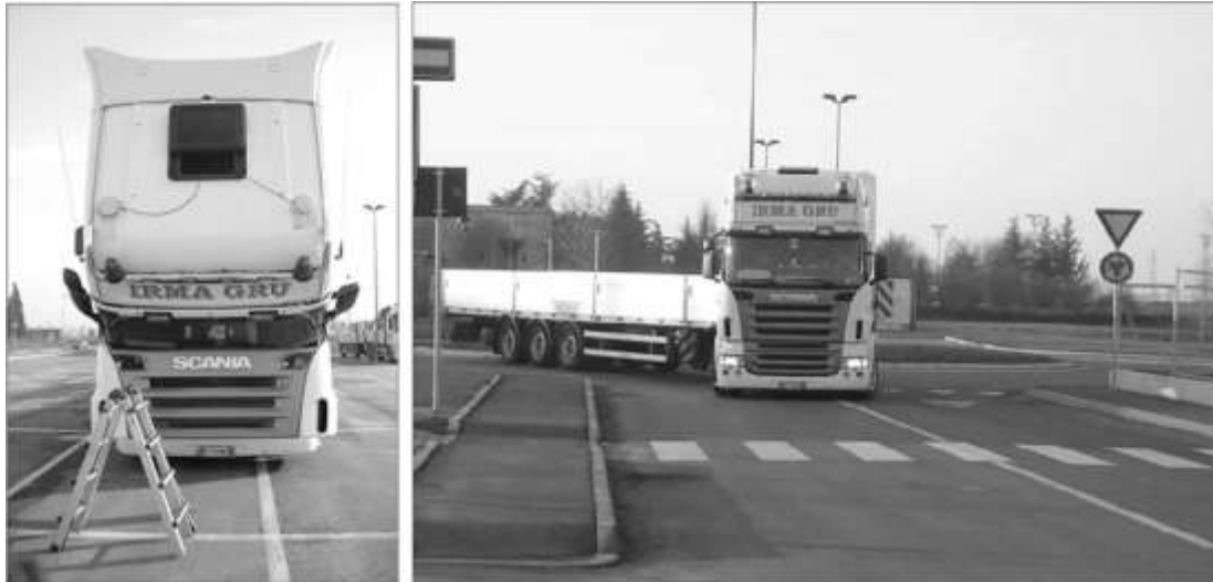
Slika 8. Položaj GPS rovera na kabini tegljača (levo), i manevar šlepera na izlasku iz kružnog toka posle skretanja pod uglom od 180° (desno) [25]
