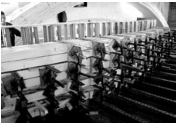
Slika 2. Proizvodnja nosača u fabrici „PIRAMIDA” iz Sremske Mitrovice
