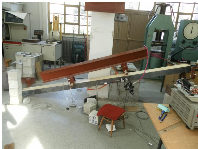
Слика 91. Претурање апаратуре услед избочавања
