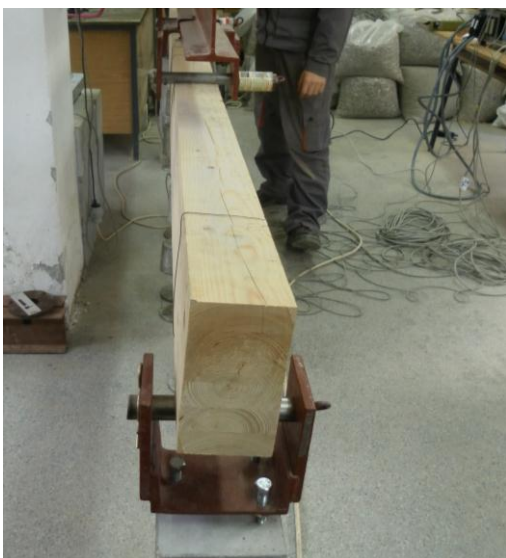
Слика 30. Почетна закривљеност пресека
