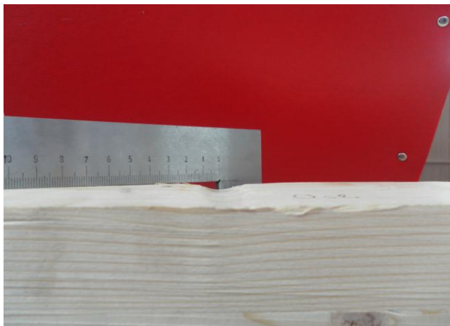
Слика 78. Гњечење дрвета код ослонца
