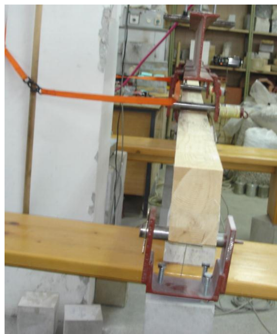
Слика 57. Унос силе преко челичних подметача Слика 58. Челични ваљци на месту уноса сила
