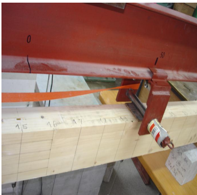
Слика 57. Унос силе преко челичних подметача Слика 58. Челични ваљци на месту уноса сила
