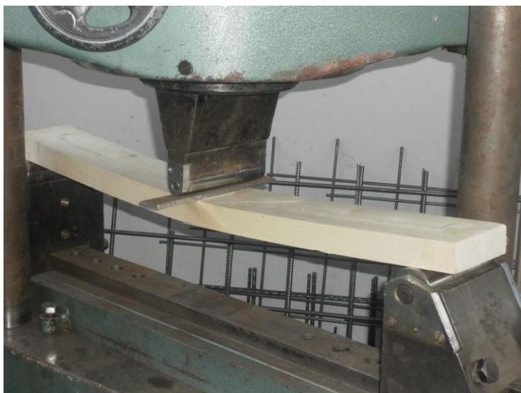
Слика 26. Уређај за савијање дрвеног узорка
