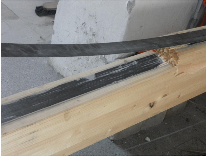
Слика 124. На месту лома лепак је издржао, али се FRP трака раслојила
