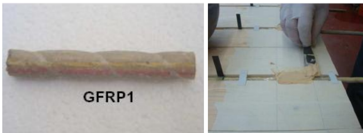
Слика 11. а. Приказ GFRP шипкасте арматуре типа Marperod G
