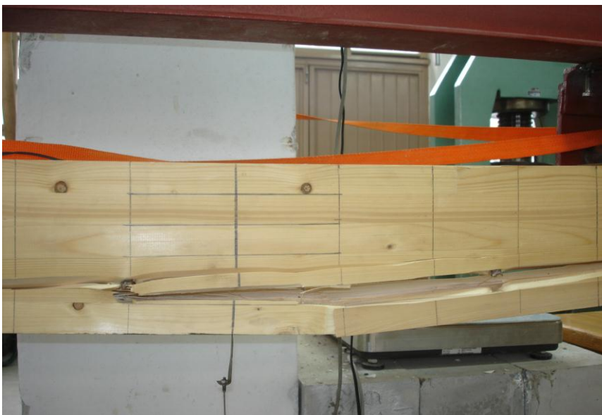
Слика 112. Лом пресека на месту зупчастог споја
