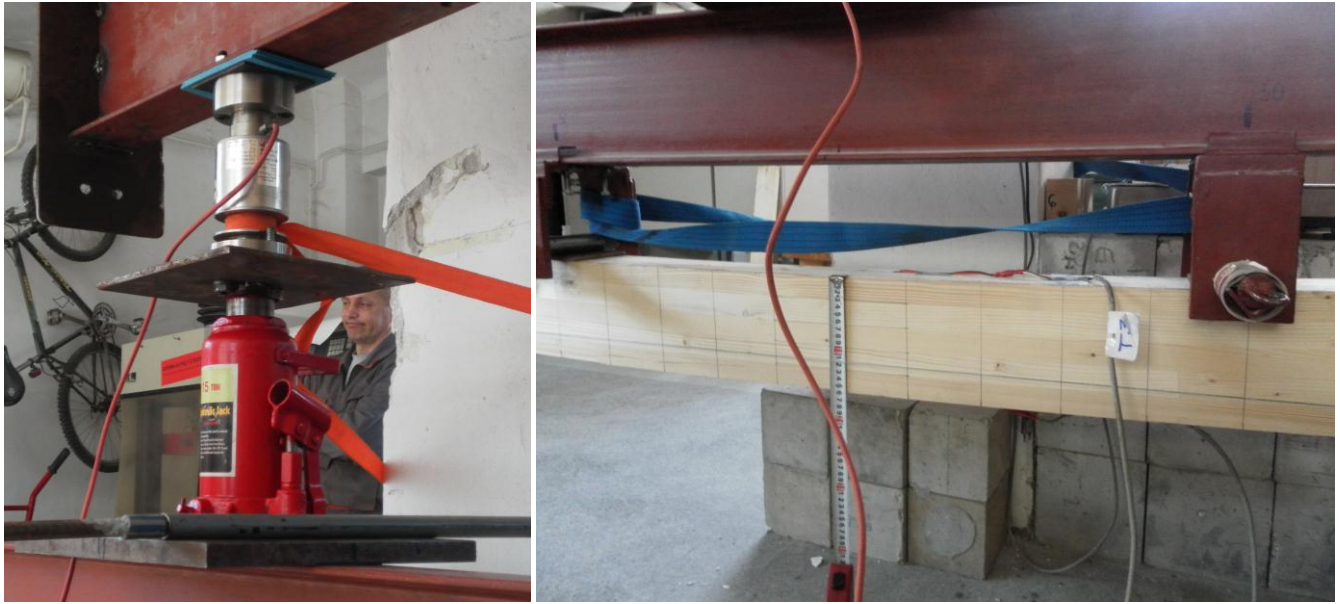
Слика 60. Унос силе хидрауличном пресом Слика 61. Мерне траке са лењиром на средини распона
