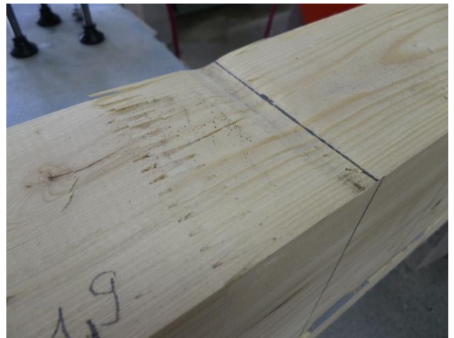
Слика 97. Гњечење дрвета код уноса силе
