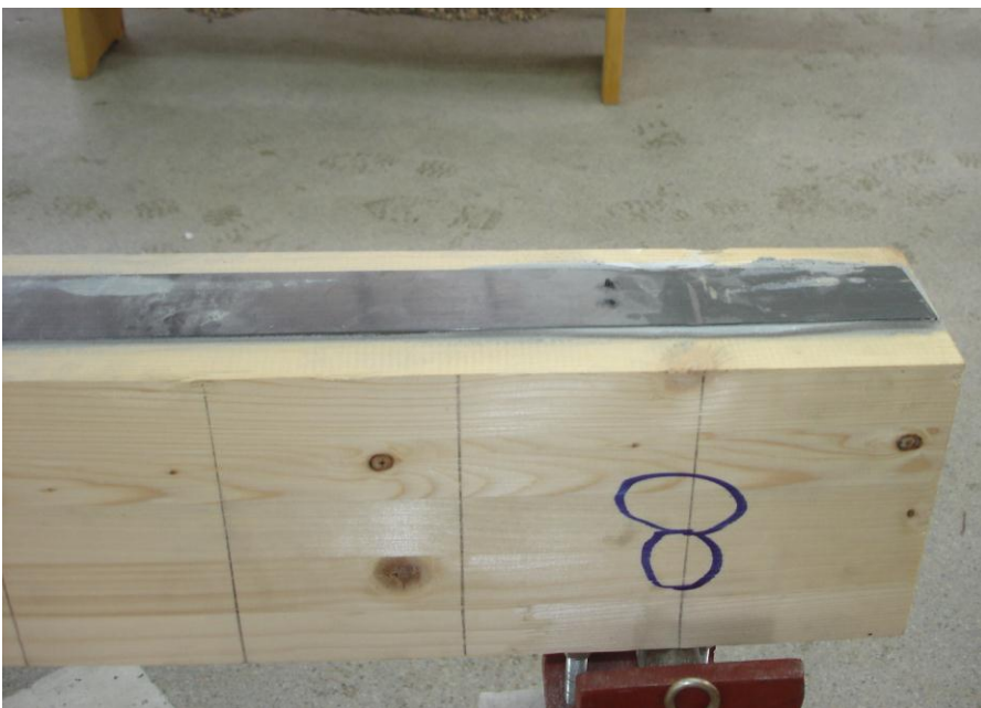
Слика 116. FRP трака смањује гњечење дрвета на месту ослонца
