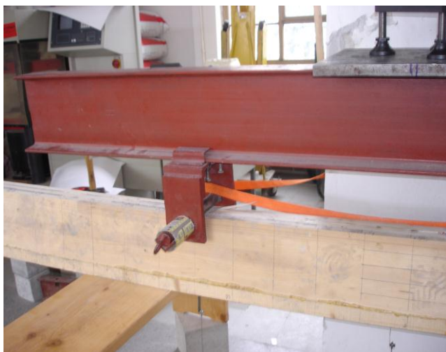
Слика 101. Гњечење влакана код уноса силе-лево Слика 102. Гњечење влакана код уноса силе десно
