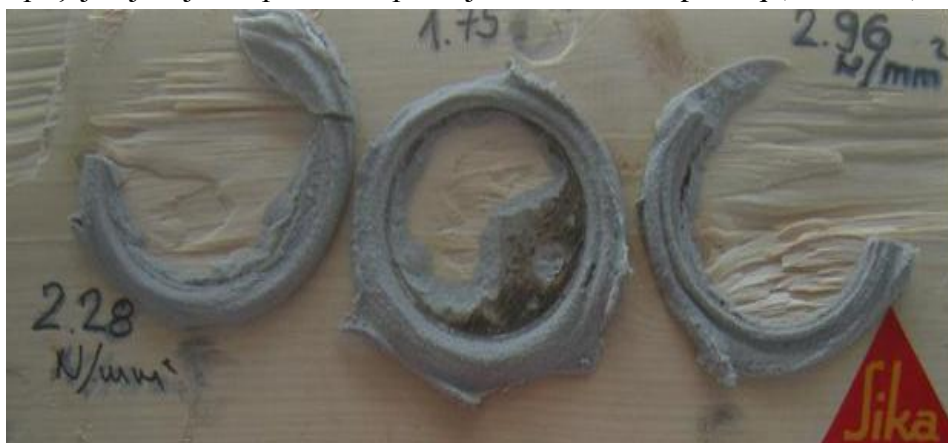
Слика 20. Испитивани отисци „pull off“ методом
