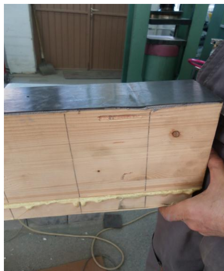
Слика 88. Одвајање FRP траке од доње ламеле Слика 89. FRP траке смањује гњечење дрвета
