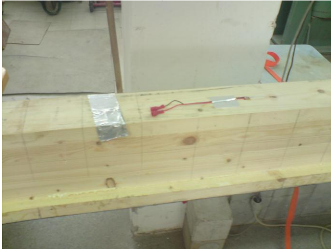
Слика 65. Мерна трака на горњој ивици греде Слика 66. Мерна трака на доњој ивици греде
