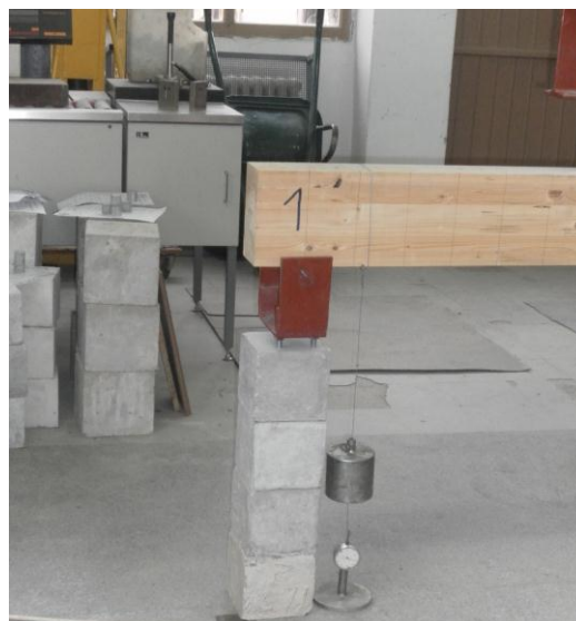
Слика 31. Детаљ ваљкастог ослањања узорка
