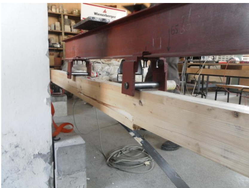
Слика 122. Формирање лома је настало испод места уноса силе у доњој ламели
