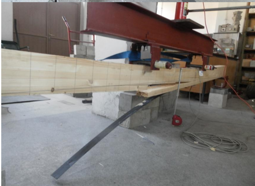
Слика 123. Лом доње ламеле се проширио ка средини пресека и на друге ламеле
