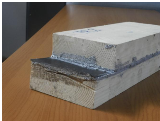
Слика 25. Зацепљење дрвене ламеле
