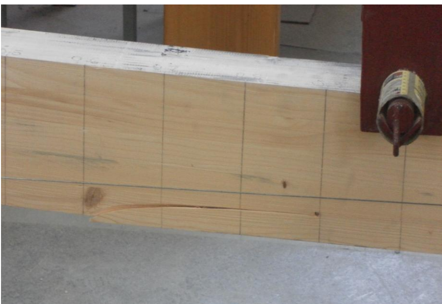
Слика 117. Локално зацепљење доње дрвене ламеле
