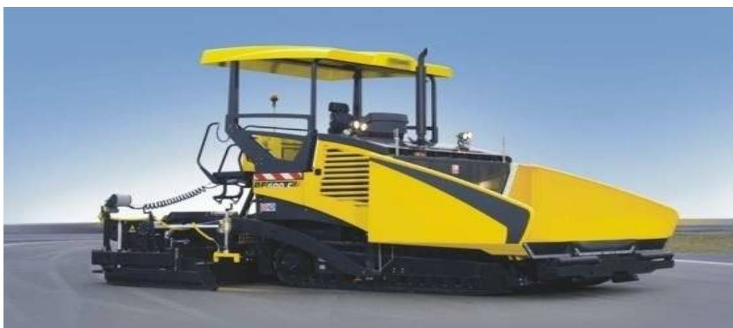
Слика 105 - Финишер гусеничар новије генерације са додатном опремом
