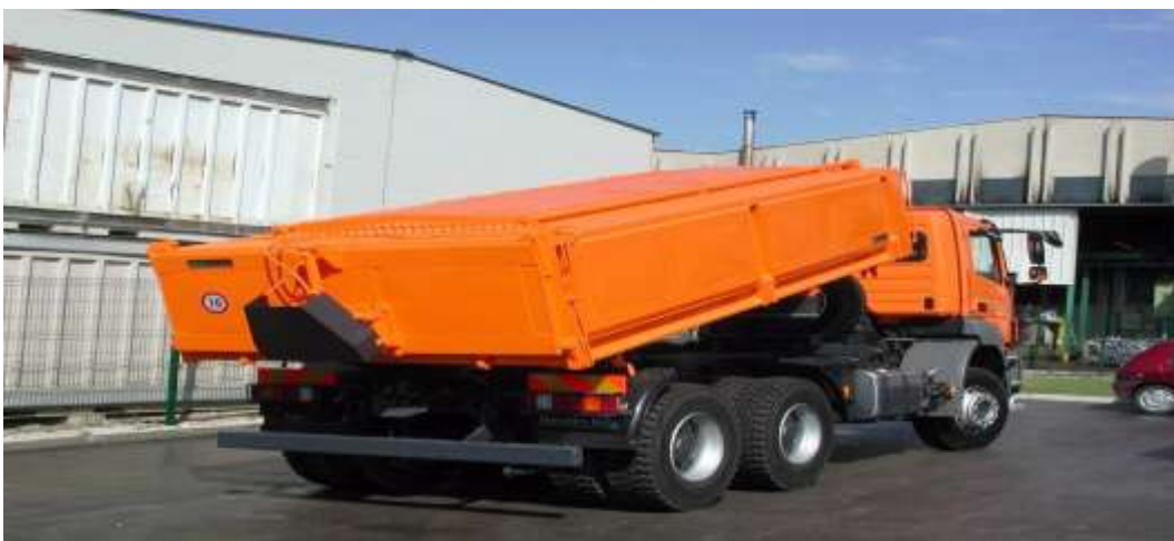
Слика 103 - Камсион за транспорт асфалтних мешавина
