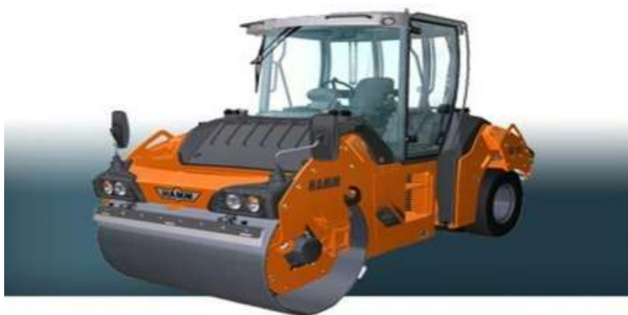
Слика 108 - Компактор са металним и гуменим ваљцима (комбиновани)
