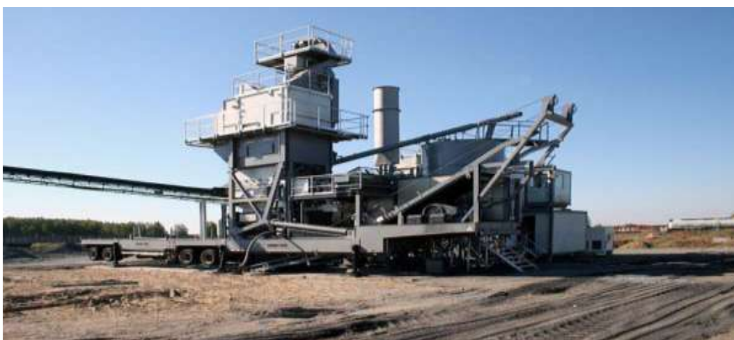
Слика 102 - Мобилна асфалтна база новије генерације
