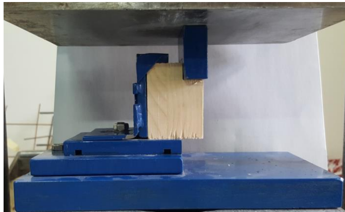
Слика 5.6 Испитивање чврстоће дрвета на смицање
