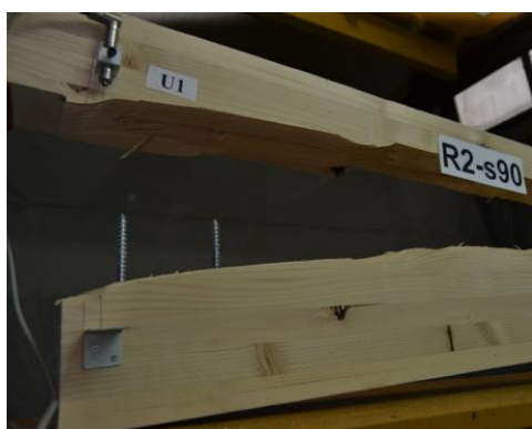
а) Чупање вертикално постављених завртњева, носач R2-s90
