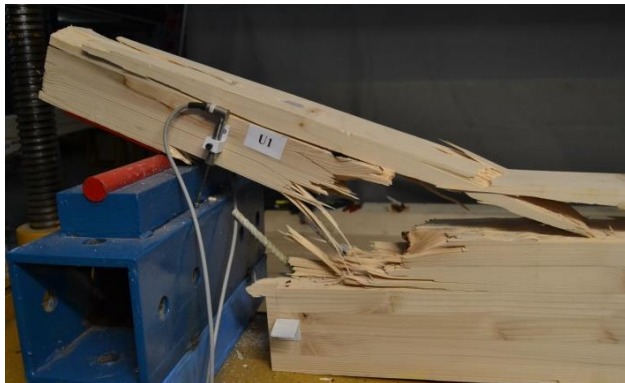
Слика 6.31 Лом носача R1-f45 услед чвора близу ослонца
