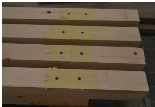
Слика 5.30 Припрема рупа за постављање GFRP шипки
