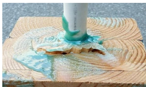
б) Смицање са извлачењем дела дрвеног пресека
