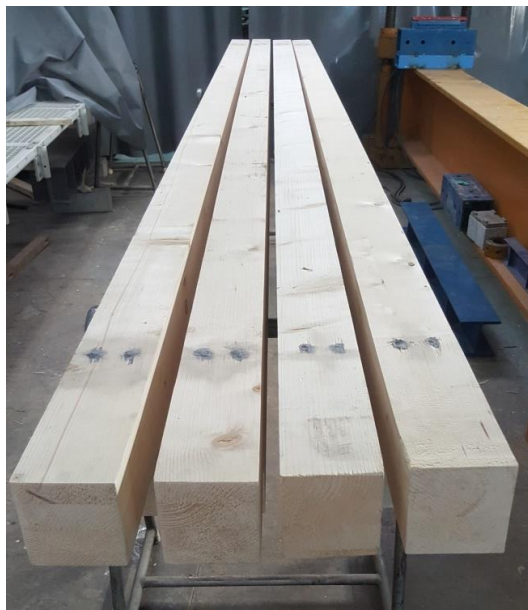
Слика 5.34 Носачи са уграђеним GFRP шипкама
