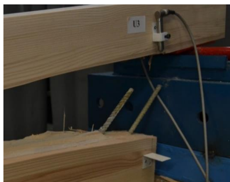
Слика 6.34 Извлачење GFRP шипки – Серија R-f45, носач R2-f45
