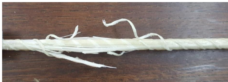
Слика 5.18 Типичан облик лома при испитивању чврстоће на затезање GFRP шипки
