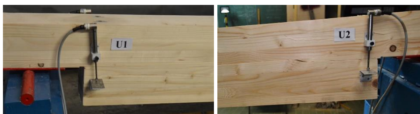
Слика 6.25 Пропагија пукотине целом дужином носача, без извлачења шипки, носач R8-f90
