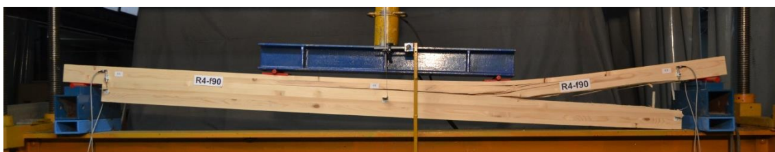
Слика 6.20 Лом услед смицања носача ојачаних вертикалним GFRP шипкама – Серија R-f90, носач R4-f90
