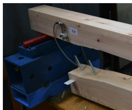
б) Чупање косо постављених завртњева, носач R3-s45
