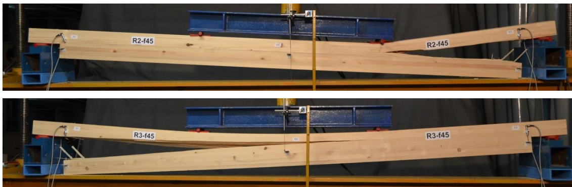
Слика 6.28 Лом услед смицања носача ојачаних косим GFRP шипкама – Серија R-f45, носачи R2-f45 и R3-f45
