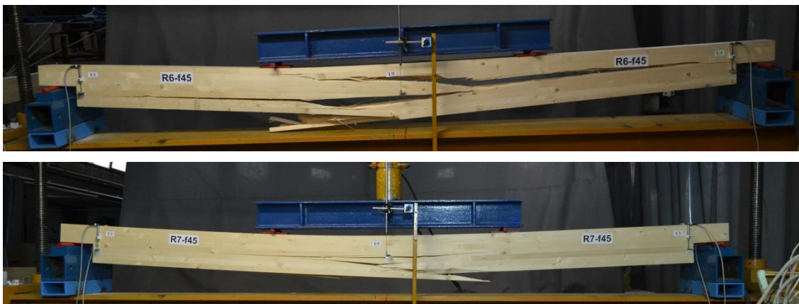
Слика 6.36 Лом услед савијања носача ојачаних косим GFRP шипкама – Серија R-f45, носачи R6-f90 и R7-f90
