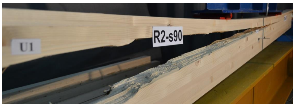
Слика 6.11 Нестабилан раст пукотине код носача ојачаних завртњевима, носач R2-s90
