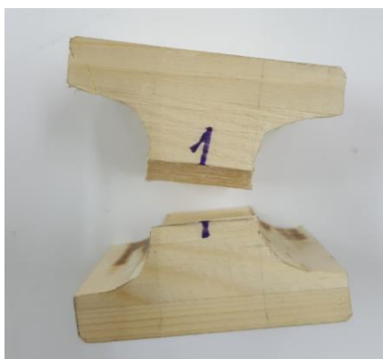
Слика 5.10 Типичан лом узорка при испитивању чврстоће дрвета на затезање управно на влакна
