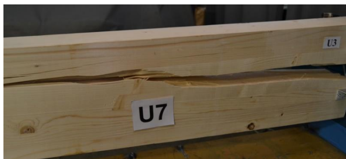
Слика 6.4 Промена правца пукотине на месту дефекта грађе дрвета – Серија U, носач U7
