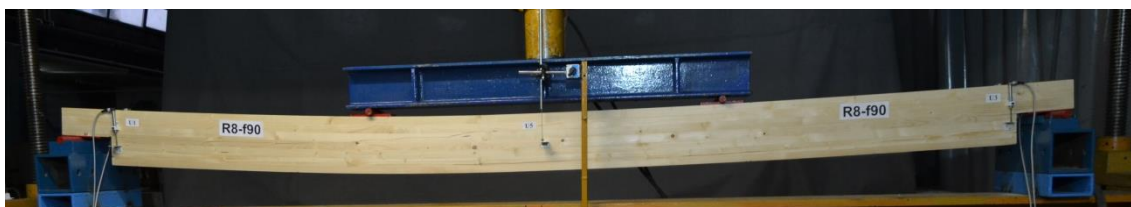
Слика 6.24 Лом услед смицања носача ојачаних вертикалним GFRP шипкама – Серија R-f90, носач R8-f90
