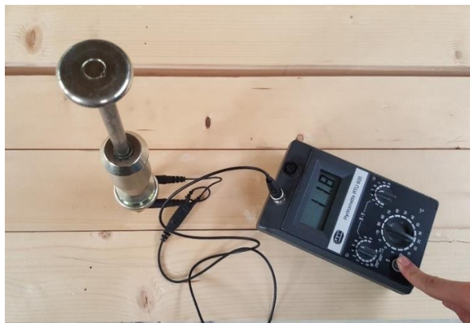
Слика 5.41 Одређивање процента влажности дрвета влагомером
