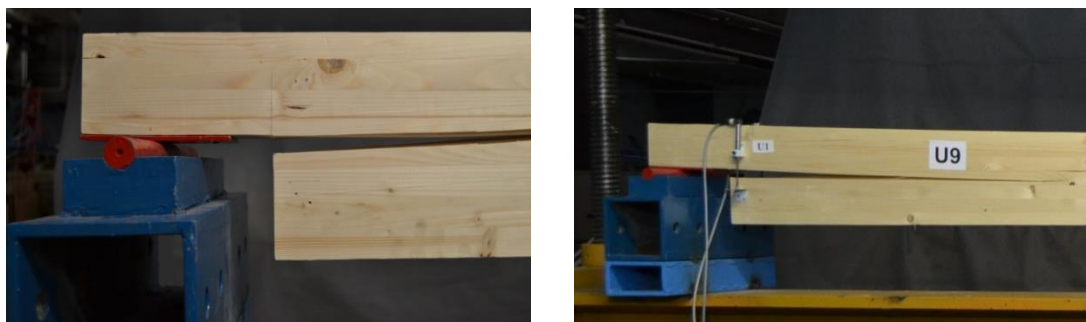
Слика 6.3 Облик лома I и путања пукотине – Серија U, носач U9
