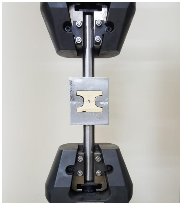
Слика 5.9 Испитивање чврстоће дрвета на затезање управно на влакна
