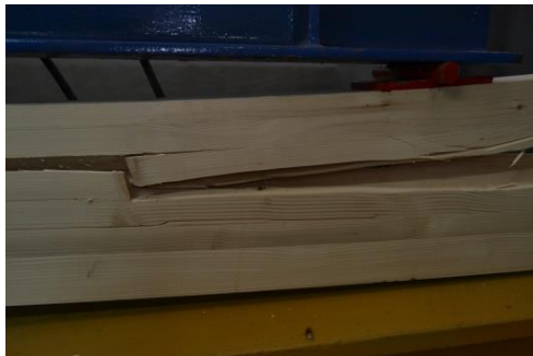
Слика 6.13 Промена правца пукотине на месту дефекта грађе дрвета – Серија R-s, носач R4-s90
