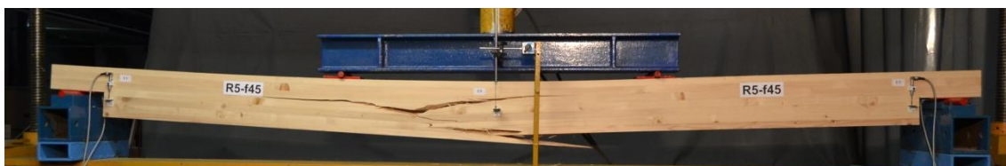
Слика 6.29 Лом услед савијања носача ојачаних косим GFRP шипкама – Серија R-f45, носач R5-f45
