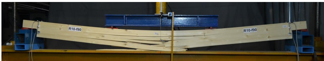
Слика 6.23 Лом услед савијања носача ојачаних вертикалним GFRP шипкама – Серија R-f90, носач R10-f90
