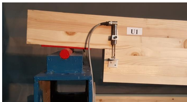
Слика 6.10 Иницирање пукотине на месту нагле промене висине код носача ојачаних завртњевима, носач R3-s90
