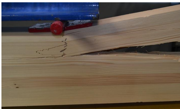
Слика 6.32 Трагови пластификације притиснуте зоне носача R2-f45
