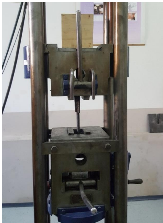
Слика 5.14 Испитивање чврстоће завртњева на чупање управно на влакна дрвета
