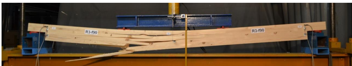
Слика 6.19 Лом услед савијања носача ојачаних вертикалним GFRP шипкама – Серија R-f90, носачи R2-f90 и R3-f90
