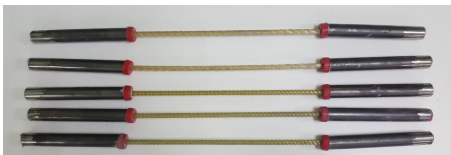
Слика 5.15 Узорак за испитивање чврстоће на затезање GFRP шипки
