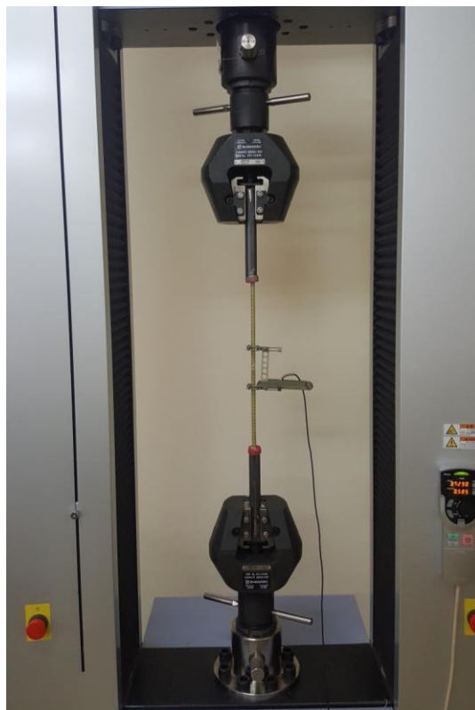
Слика 5.16 Испитивање чврстоће на затезање GFRP шипки
