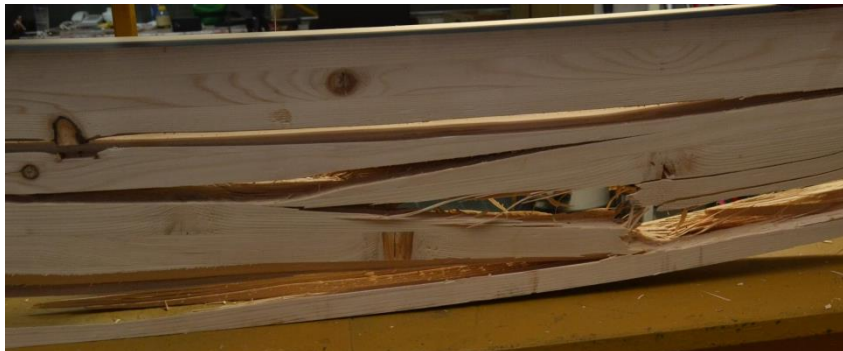
Слика 6.21 Лом носача услед затезања у доњој зони на месту кврга у дрвету – Серија R-f90, носач R2-f90
