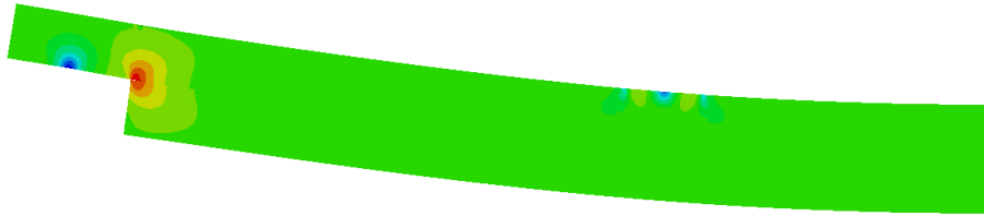
Слика 8.15 Тренутак отварања пукотине носача Серије U при напону затезања управно на влакна \sigma_n = 1,15 \text{ N/mm}^2
