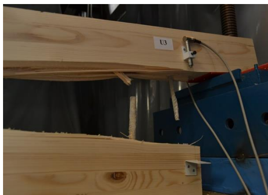
Слика 6.22 Извлачење GFRP шипки – Серија R-f90, носач R4-f90
