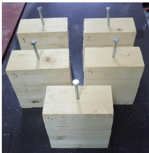
Слика 5.13 Узорци за испитивање чврстоће завртњева на чупање управно на влакна дрвета
