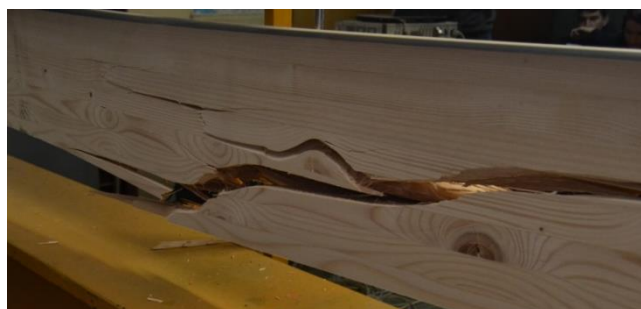
Слика 6.35 Лом носача услед затезања у доњој зони на месту кврга у дрвету – носач R5-f45
