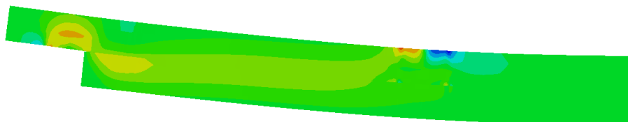
Слика 8.18 Смичући напони у носачу са вертикалним завртњевима, тренутак пропагације пукотине преко другог завртња \sigma_s = 5,85 \text{ N/mm}^2
