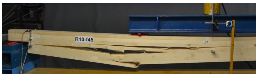
Слика 6.38 Лом носача услед затезања у доњој зони на месту кврга у дрвету – носач R10-f45
