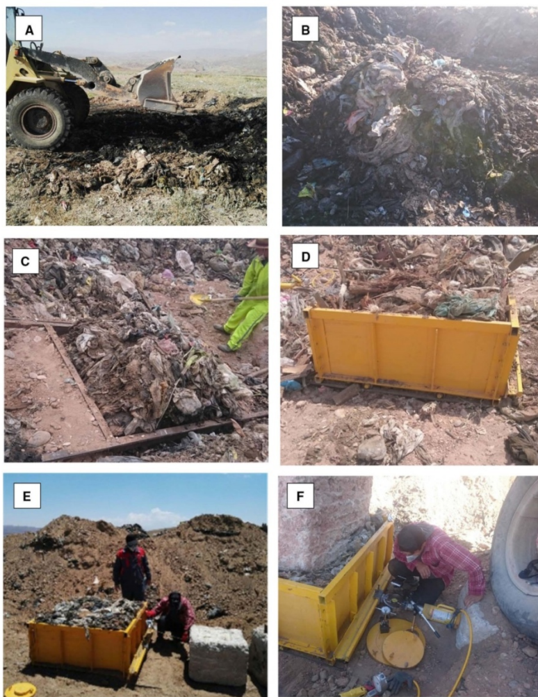
Slika 3.11 Izvođenje opita direktnog smicanja in situ (Keramati et al., 2020)
