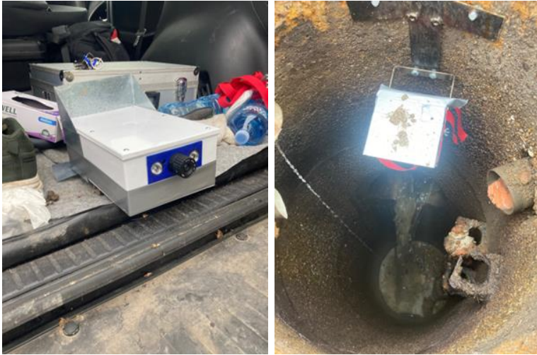
Slika 2. Levo: Kućište mernog uređaja sa vidljivim izloženim objektivom kamere i diodama. Desno: Merni uređaj montiran u šaht. Figure 2. Left: Measuring device (MD) housing with exposed lens and IR light diodes. Right: MD mounting position in the manhole.
