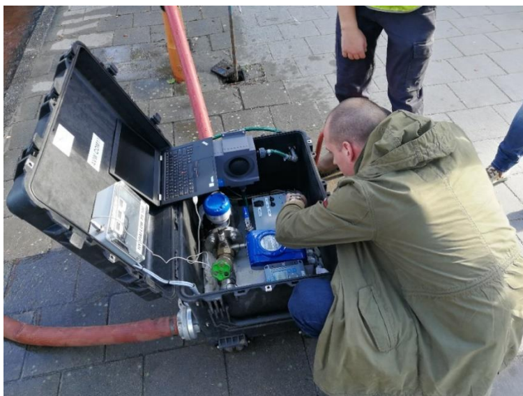
Slika 1. Kofer sa opremom za merenje protoka, pritiska i mutnoće pri primeni IJP (Amsterdam, Holandija)
