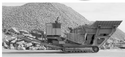
Slika 3. Struktura i izgled mobilnog reciklažnog postrojenja
