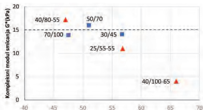
Slika 10. Kompleksni modul smicanja određen na temperaturi T_{PK} sa frekvencijom 10 rad/s [5]
