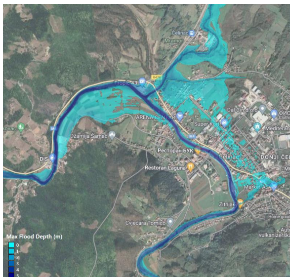
Slika 4. Mapa dubina plavljenja za modelirane velike vode T100 na području Čelince – postojeće stanje
