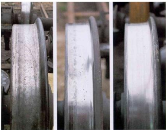
Slika 6 - Karakteristično stanje površine bandaža u slučaju primene kočne papuče od sivog liva (levo), papuče sa oblogom od kompozitnog materijala (sredina) i disk kočnice (desno)[6]
