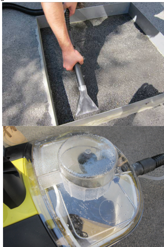
Slika 2 Uzorkovanje sa nepropusne površine – metoda mokrog usisavanja
