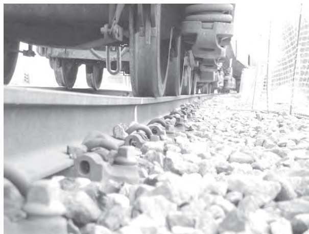
Slika 1. Primer vitoperenja koloseka pod vozilom
