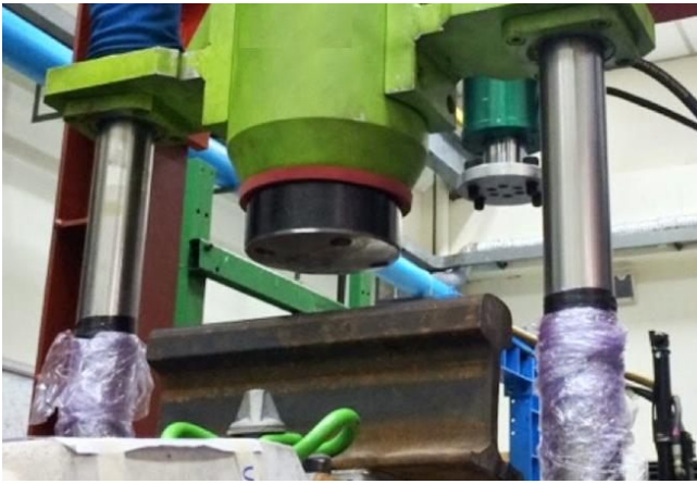
Slika 3. Postavka ispitivanja za određivanje prigušenja udarnog opterećenja
