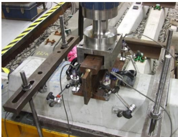
Slika 8. Postavka ispitivanja za merenje vertikalne sile neophodne za odvajanje šina od osloničke konstrukcije u laboratoriji
