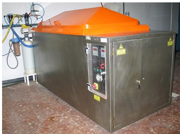
Slika 7. Oprema za ispitivanje pomoću slanog spreja Figure 7. The equipment for the salt spray test
