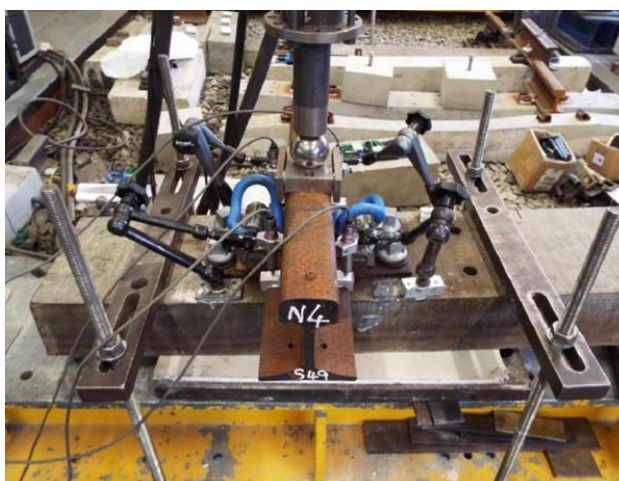
Slika 10. Postavka ispitivanja za dinamičku krutost kompletnog sklopa pričvršćenja Figure 10. Dynamic stiffness test arrangement for complete rail fastening assemblies
